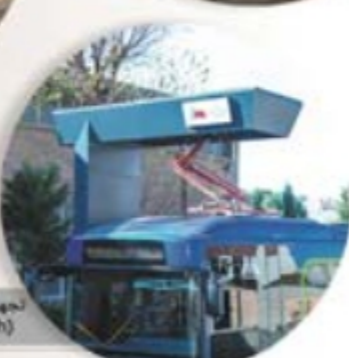
تجهیزات ایستگاه شارژ اتوبوس برقی (پانتوگراف) (Electrical Bus Charger (Pantograph))
